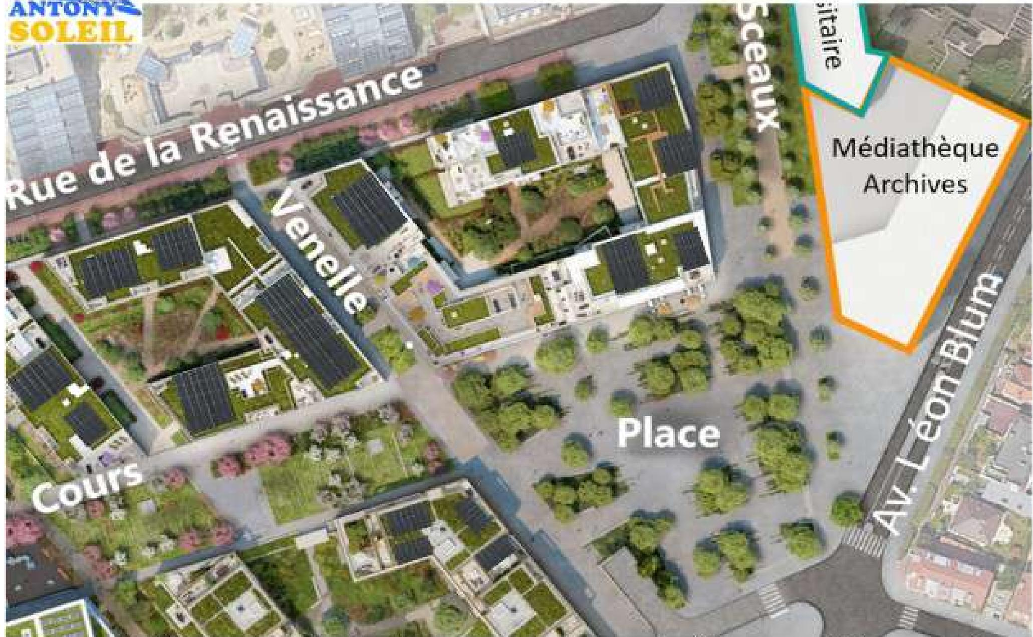
Toiture végétalisée et PV : Selon les chercheurs allemands, la présence d'une couverture végétale augmente de 8% en moyenne, la performance d'une installation photovoltaïque en toiture. Plus la distance entre les panneaux et la verdure est faible, plus l'avantage est grand.
